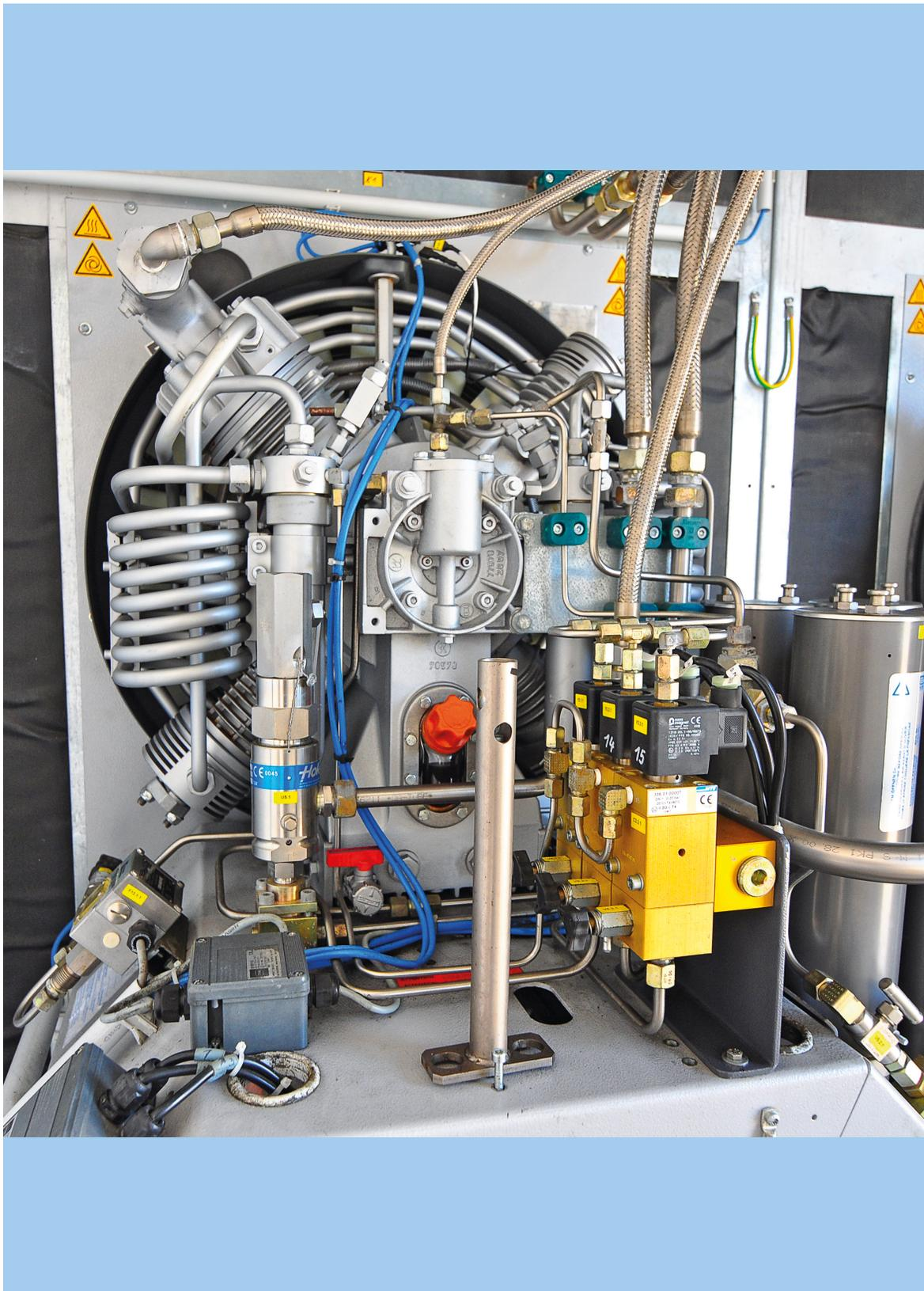
AF 16. Vista en detalle del motor del compresor
