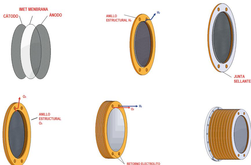
Figura 13. Secciones y disposición de la celda electrolítica en el stack
