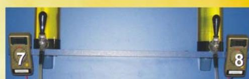
1. Carga as columnas de auga ata arriba e sitúas os polímetros 7 e 8 na posición X.
