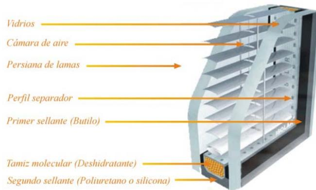
**ILUSTRACIÓN 20** Esquema del montaje de las ventanas
