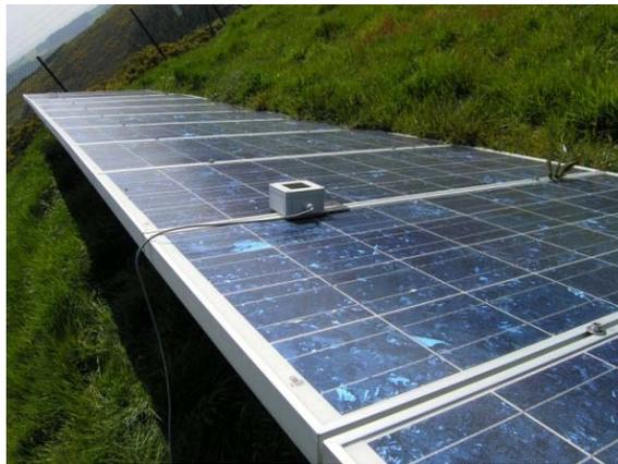
ILUSTRACIÓN 20 Sensor de radiación apoyado sobre un panel FV en una toma de medida
