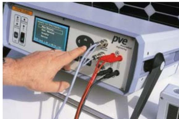
ILUSTRACIÓN 9 Trazador de curvas I-V PVPM1000C40
