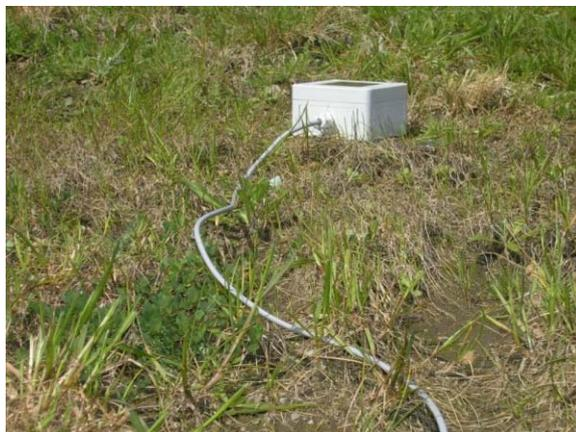
ILUSTRACIÓN 21 Sensor de radiación puesto horizontalmente para las medidas en cuadro eléctrico
