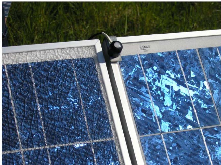
ILUSTRACIÓN 12 Fotografías panel FV IBC-120 astillado (izquierda) y normal (derecha)
