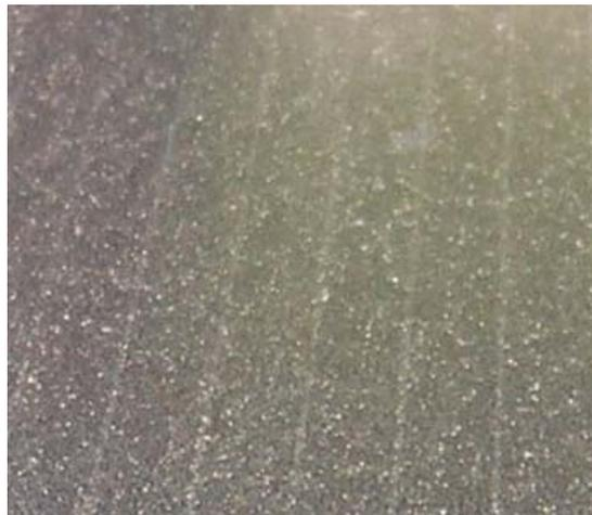
ILUSTRACIÓN 16 Capa de polvo sobre panel FV ST40
