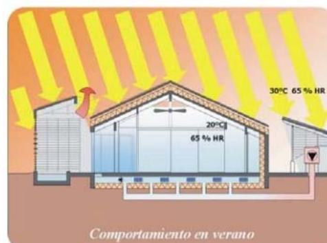
ILUSTRACIÓN 19 Utilización de la radiación solar en verano
