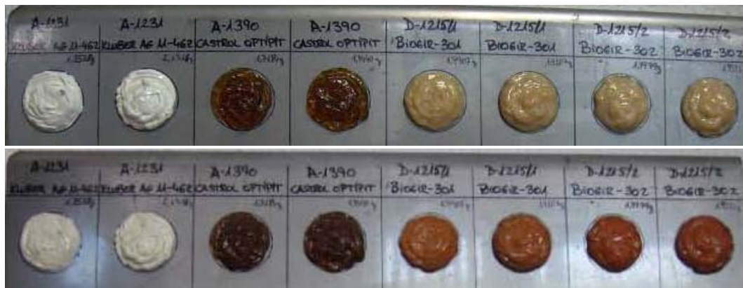
Figura 27. Ensayo comparativo de adherencia para 2 ml de grasa. Imagen superior (12/04/2010), inferior (19/07/2010)
