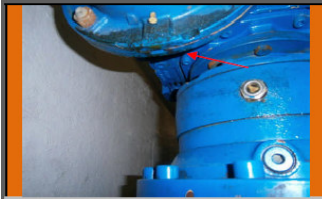
Fugas reductoras de giro.
