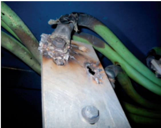
Figura 2. Detalle siniestro de transformador por puesta a tierra del cableado interruptor ppal-transformador.
