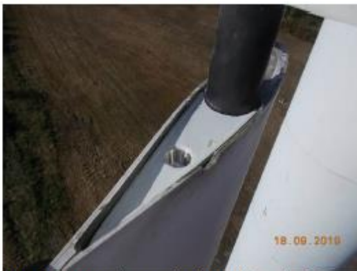
Foto 3: Proceso de pegado de costilla punta-BS
