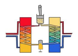
Tienen un fluído dentro muy frío que se evapora al coger calor de una fuente más caliente (suelo, aire...). Entra en un compresor, donde, con un pequeño consumo eléctrico, se comprime para aumentar más su temperatura. De esta forma, por intercambio de calor calienta el aqua de nuestro depósito.
