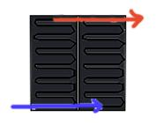
Concentran la radiación solar para, a través de un cristal, calentar el fluído que circula por unos tubos (normalmente agua con anticongelante). El calor acumulado calienta el agua de un depósito y se emplea para calentar el auga de uso mediante un intercambiador de calor.
